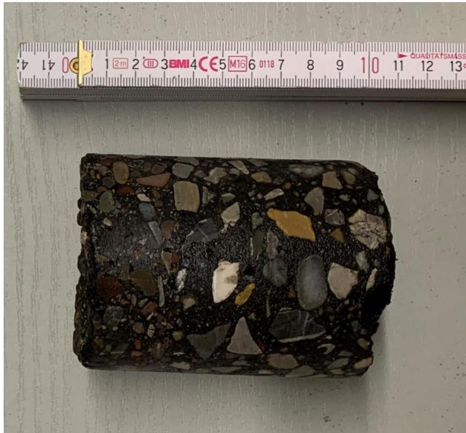
Abb. 2: Asphaltbohrkern AB2, Stärke 9,5 cm
