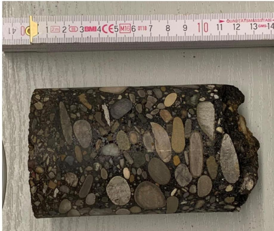
Abb. 1: Asphaltbohrkern AB1, Stärke 13 cm
